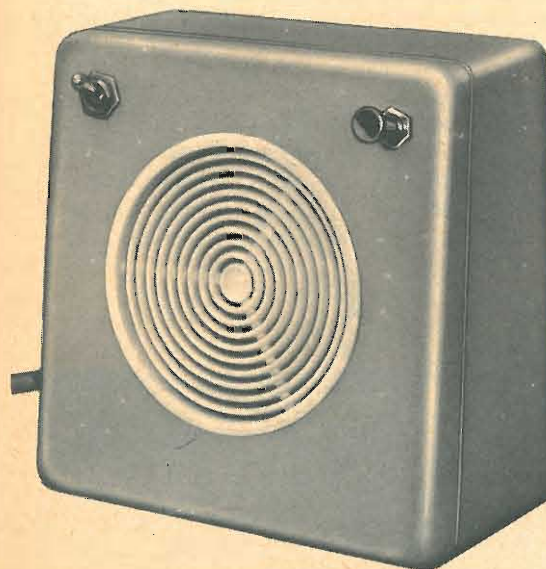
Fig. 2 - Parte anteriore del posto principale dell'interfono.
