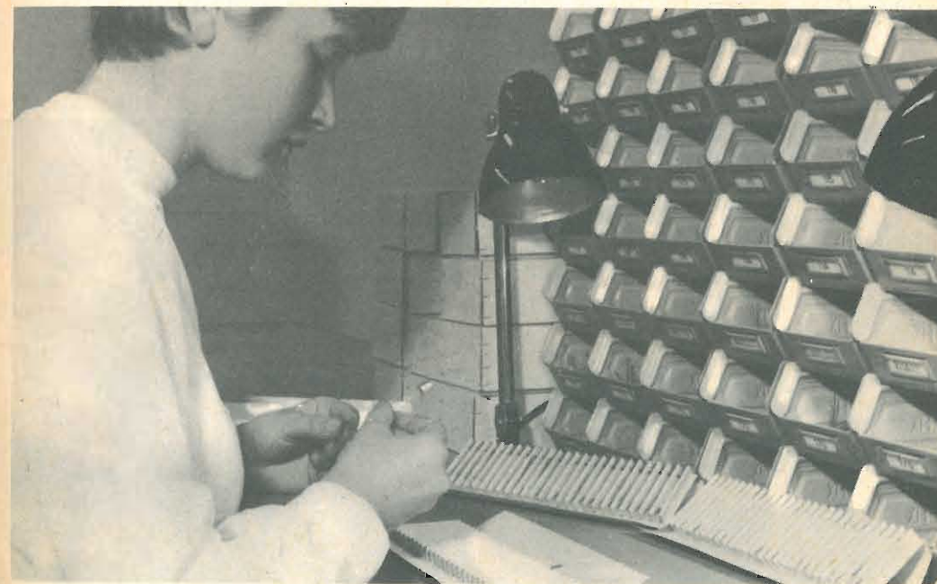
Una fase di controllo (100%) dei transistor alla Fabbrica Semiconduttori della Philips S.p.A. - Monza.
