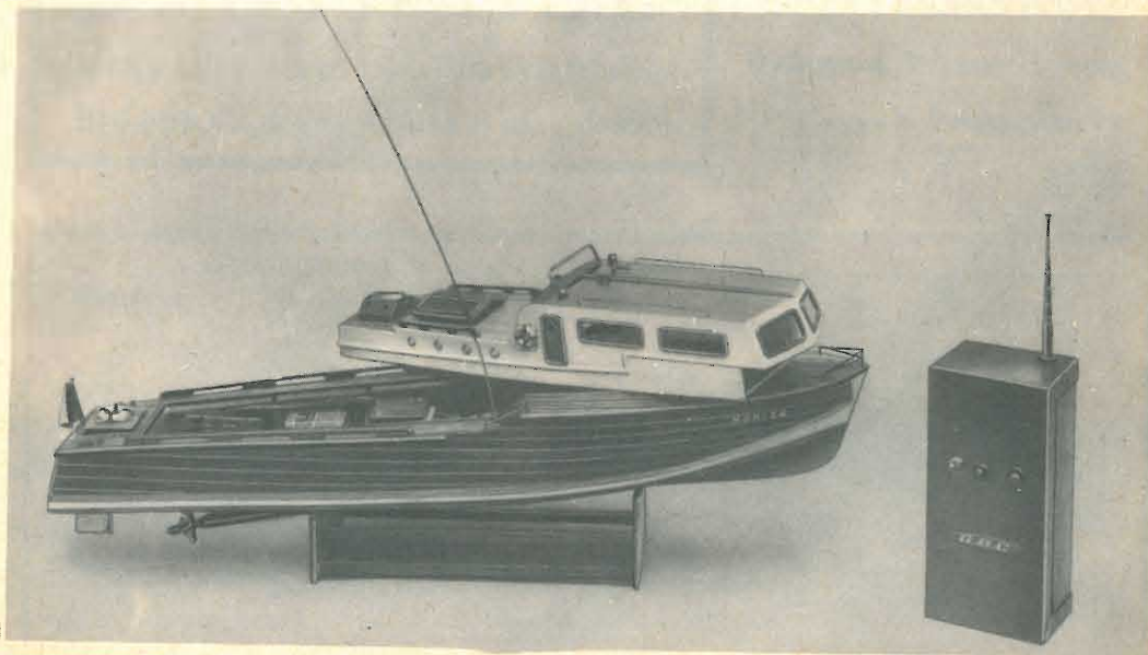
Modello navale « Vedette » completo di ricevitore RX-10, batterie e servomeccanismo « Rotomatic »; accanto si trova il trasmettitore TX-10.
